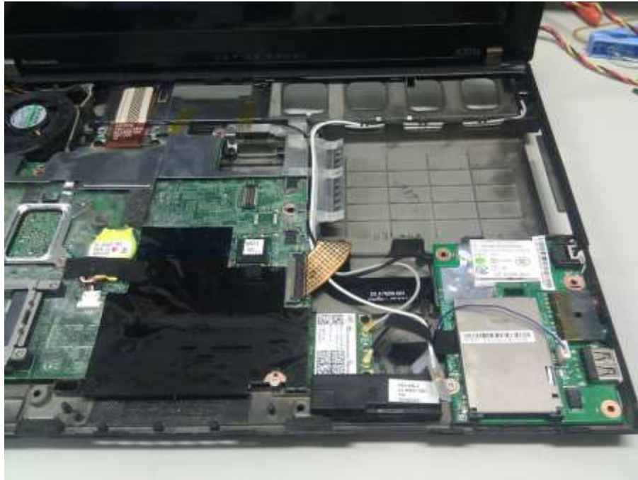
Figure 2 Intel WLAN+WiMAX カードと空きスロット
