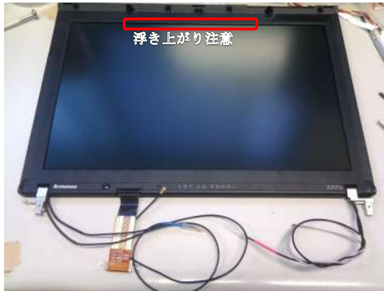
Figure 10 WWLAN アンテナ付き LCD アセンブリ完成、上部の浮き上がりに注意
