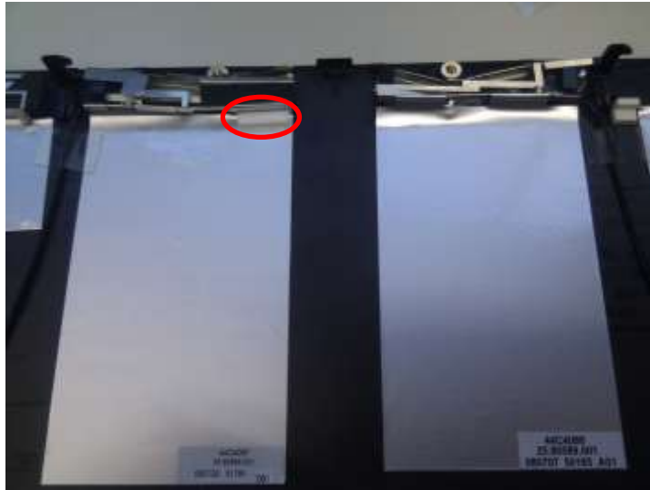
Figure 9 2枚のアンテナの取り付け完成
